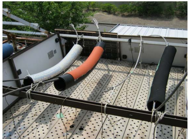
図9 日射による電線温度の確認試験状況
