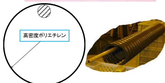
図5 高密度ポリエチレン管を用いた絶縁防護
