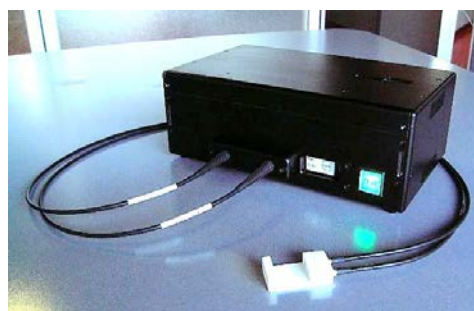
図2 紫外吸収分光法を用いた小型ガス濃度計測装置の構造(左)と外観(右)
