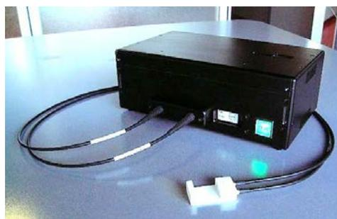
図2 紫外吸収分光法を用いた小型ガス濃度計測装置の構造(左)と外観(右)
