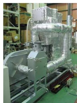
写真1 10 N m<sup>3</sup>/min 循環加熱式 試作機
