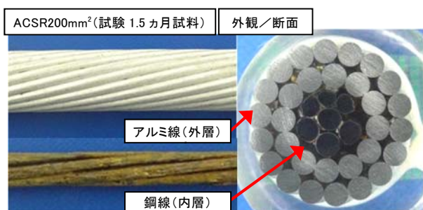
図5 腐食促進試験における試料の腐食様相例
