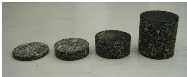
図 3 アスファルトコアの外観
