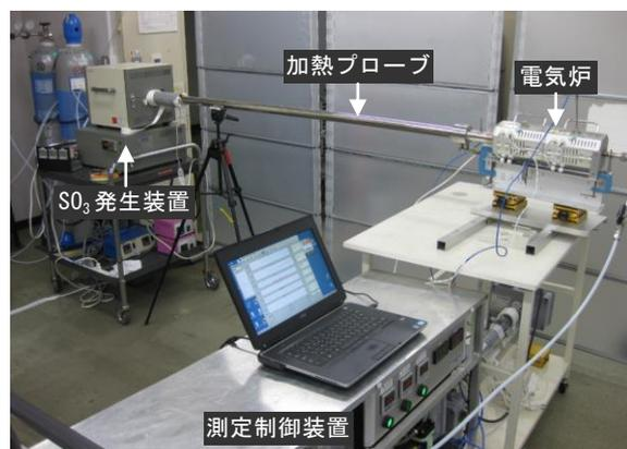
図 10 実験室での試験状況 (SO<sub>3</sub> 発生装置使用)
