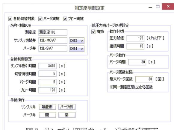
図7 サンプル切替弁・パージ弁設定画面
