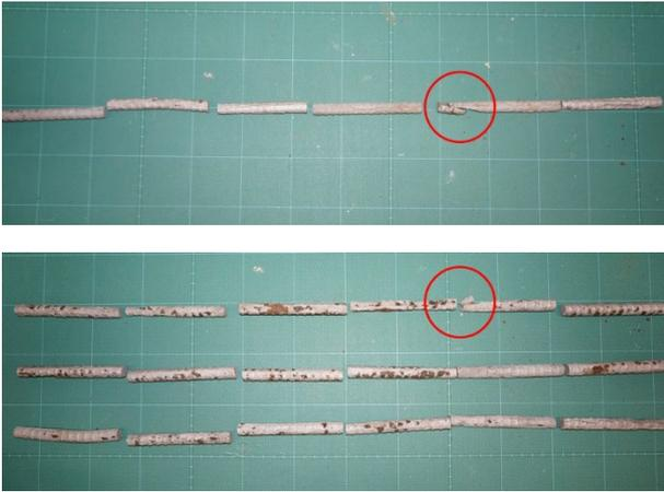
図 44 腐食欠損状況
