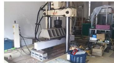
図 41 梁載荷試験
