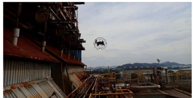
図11 煙道温度測定状況
