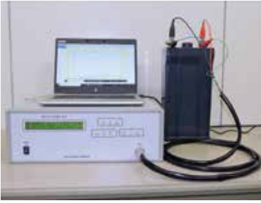
蓄電池劣化特性試験装置
