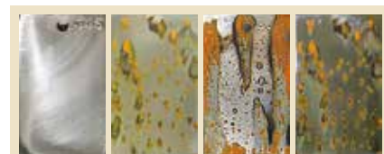
腐食試験の一例
