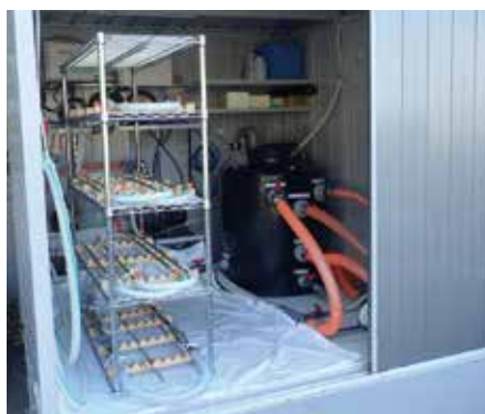
実海水を用いた伝熱性能評価試験
