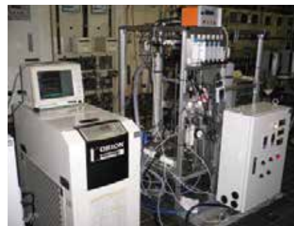
高温水中での腐食試験
