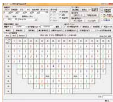
熱交換器内部スケールのECT波形管理画面
