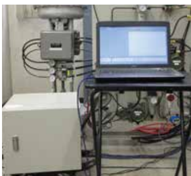
主給水制御弁動特性試験装置
