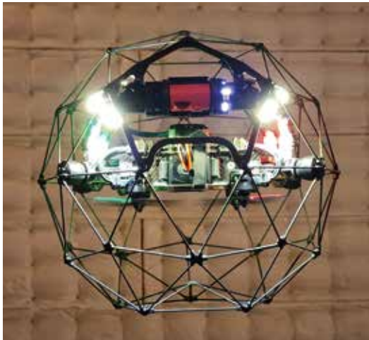
屋内点検用ドローン(ELIOS 2)
