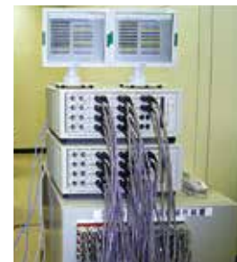
非常用予備発電装置 機能検査用試験装置
