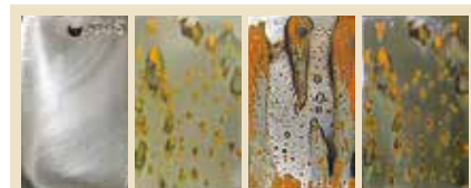
腐食試験の一例
