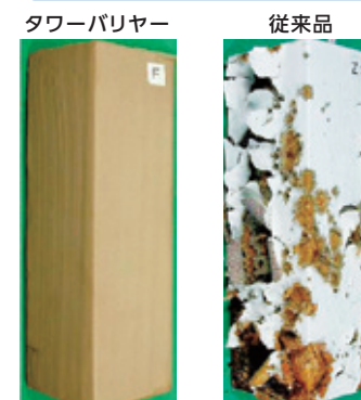
基材：経年鉄塔部材 試験：500サイクル
