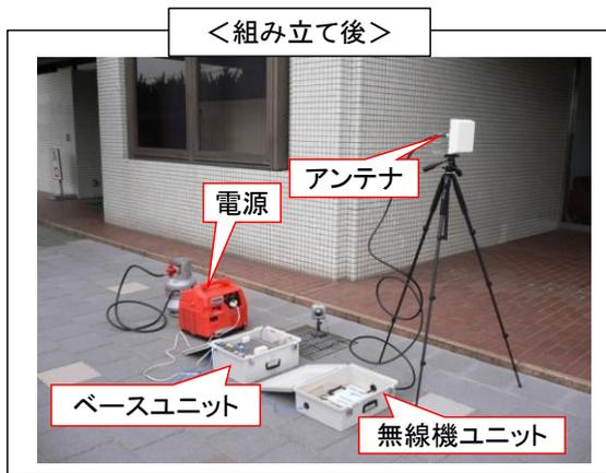
図5 プロトタイプ機の外観（組立て後）
