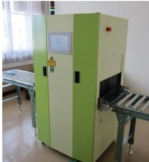
写真 1 レーザータイプの照射装置
