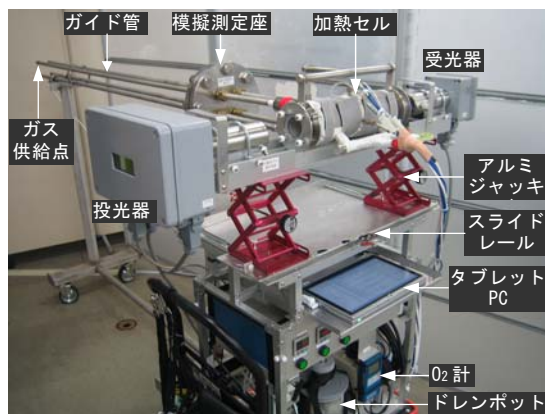
図 12 実験室での試験状況
