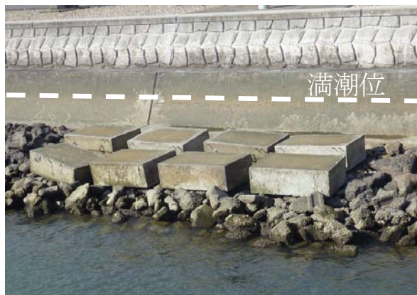
写真-1 屋外暴露試験状況(干満帯)
