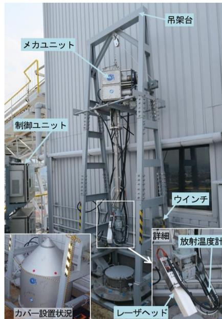
図2 装置外観(装置上架時)
