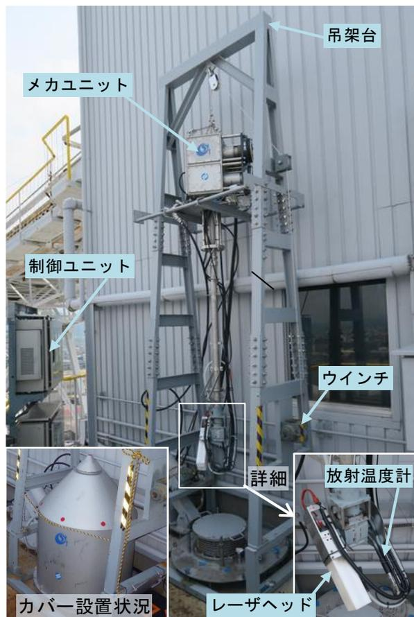
図2 装置外観(装置上架時)
