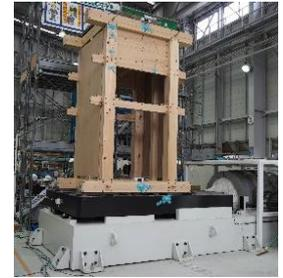
図 7 加振試験状況
