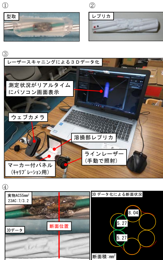
図 7 3D データを応用したより線残存引張荷重推定
