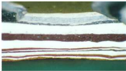
図1 剥離した塗膜の断面
