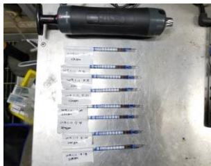
(b) 手分析測定(検知管) (c) 手分析値－測定値相関 図 16 手分析比較試験
