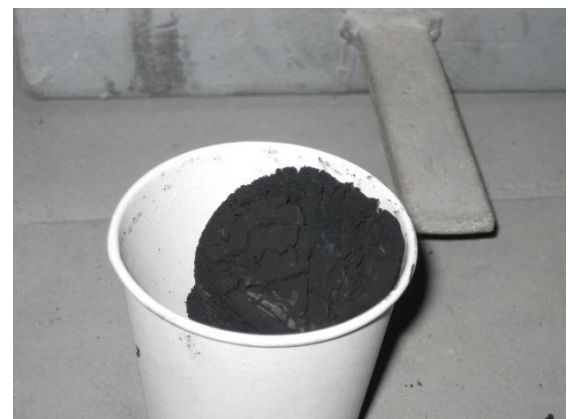
図2 サンプルガス中の煤塵(未燃微粉炭・石炭灰)
