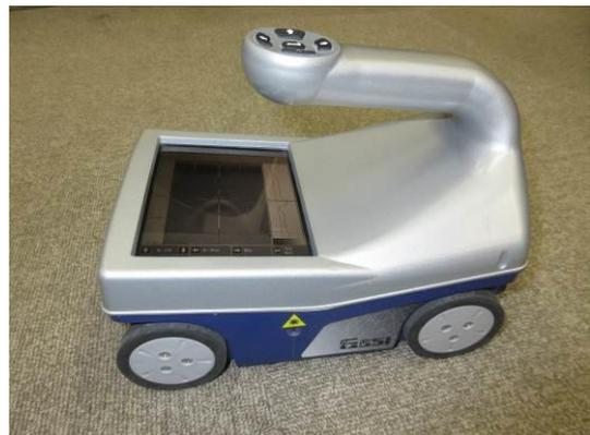
図2 電磁波レーダ探査装置の例
