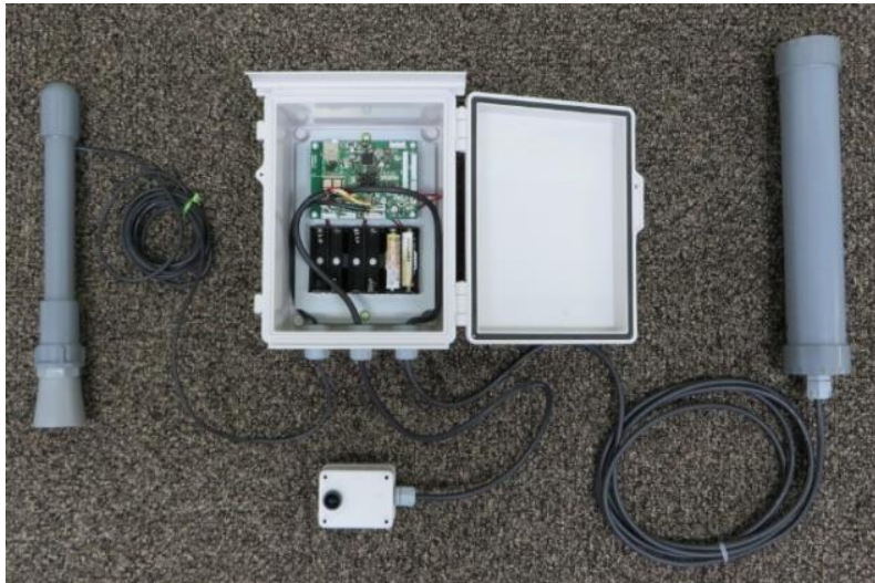
図1 水位モニタリングセンサユニット
