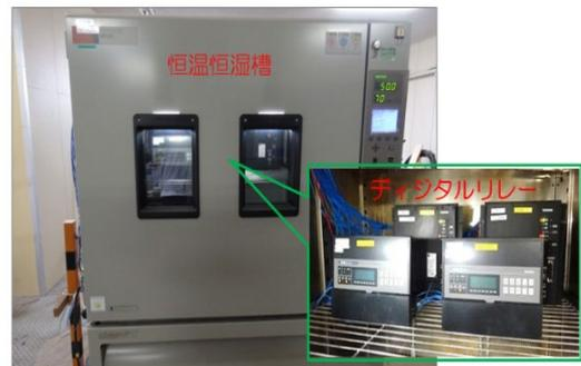
図4. 加速劣化試験状況
