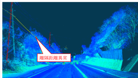
離隔距離異常発生箇所 (点群)
