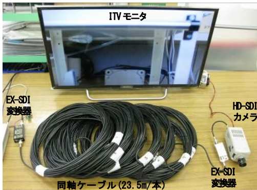
図 6 HD-SDI 信号伝送試験状況(ラボ)
