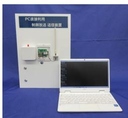
図13 制御指令PC直接送信装置
