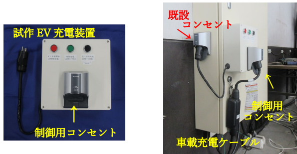
図 3 放送型制御機能を搭載した EV 充電装置
