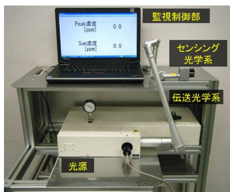
図 12 監視制御部を含む装置外観
