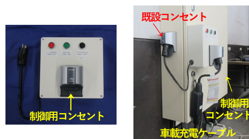
図 14 放送型制御機能を搭載した EV 充電装置
