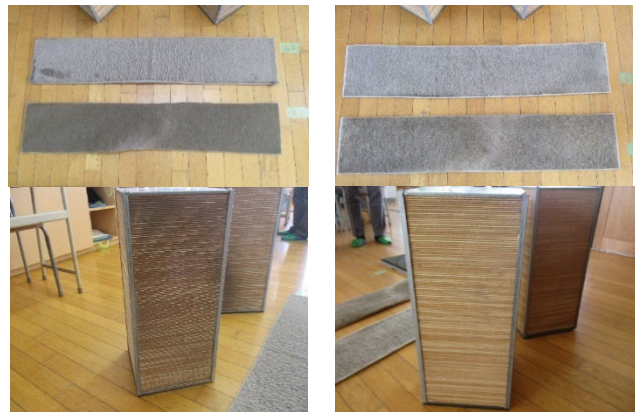
図 28 清掃前後のフィルター・エレメントの状況 (左：清掃前，右：清掃後)
