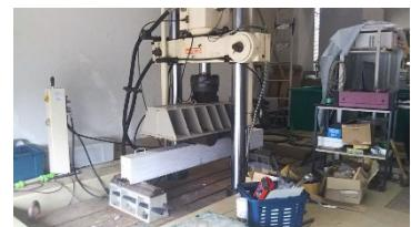
図 41 梁載荷試験
