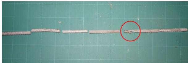
図 44 腐食欠損状況
