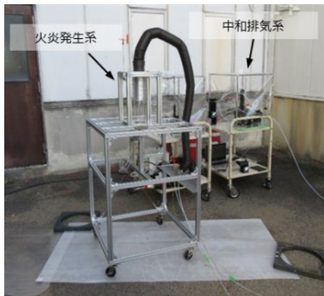
図1 アンモニア火炎発生装置外観
