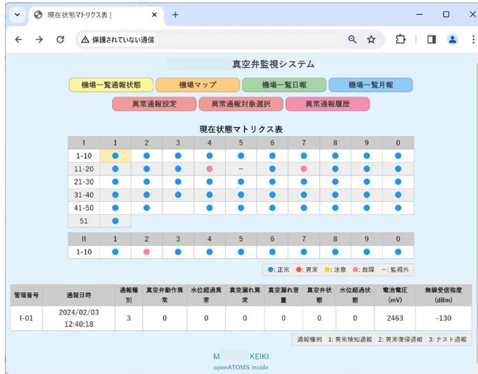
図1 真空弁遠隔監視システムのWEB トップ画面
