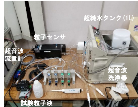
図3 粒子センサ基本性能確認試験状況
