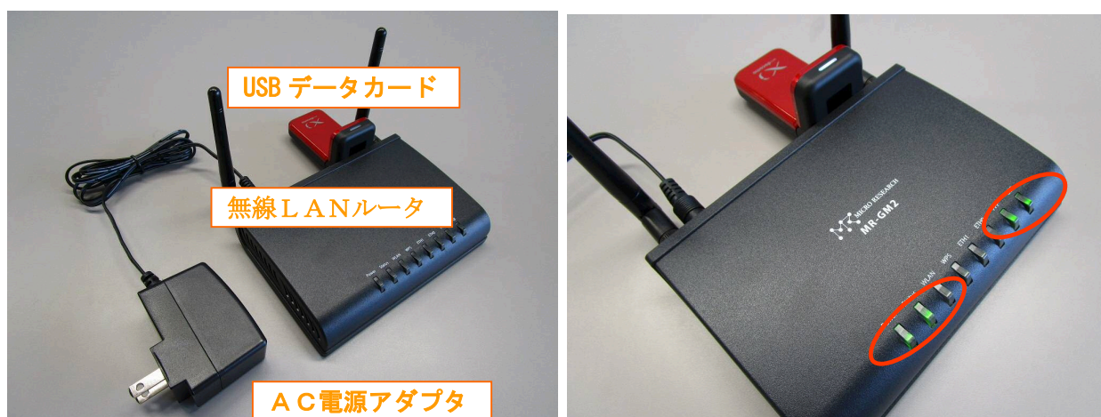
電源投入および通信状態確認
