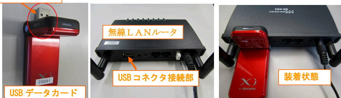
USB データカードのルータへの装着方法
